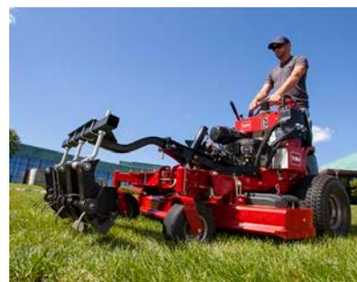
Effectuez jusqu'à six trous par pied carré avec l'aérateur de 38 po de largeur. Les dents percent le sol profondément, saisissent et soulèvent les carottes de terre qui se dispersent rapidement et répandent les éléments nutritifs à la surface.
