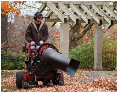
Le souffleur Pro Force possède une buse rotative sur 360° et utilise un moteur MULTI FORCE Kohler® Command Pro™ de 26,5 cv à injection électronique produisant une puissance d'air énorme pour enlever rapidement les rognures de gazon, les feuilles et les autres débris.
