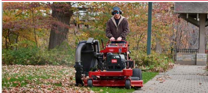
L'ensacheur double souple à montage latéral et en instance de brevet possède une grande capacité de 0,28 m<sup>3</sup> (8 boisseaux) (10 pi<sup>3</sup>) et le souffleur à montage vertical offre une excellente manœuvrabilité dans les espaces restreints et une visibilité maximale.
