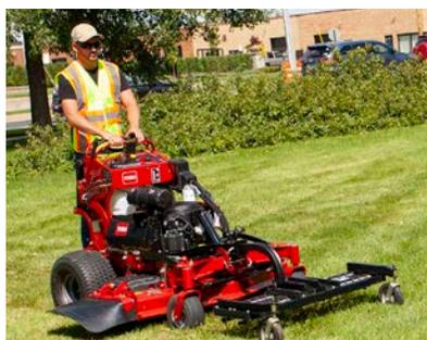
Transformez votre tondeuse en outil de nettoyage du printemps ultime avec la déchaumeuse râteau à dents à montage avant MULTI FORCE. Utilisez le râteau pour enlever le feutrage, les feuilles compactées et les débris.
