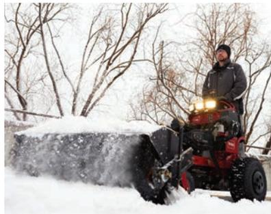
Balai motorisé de 139,7 cm (55 po) conçu pour nettoyer les trottoirs et déplacer la neige et les débris sur le pavé.
